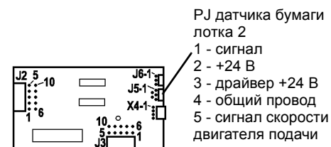
Рисунок 5 PWB управления лотка
