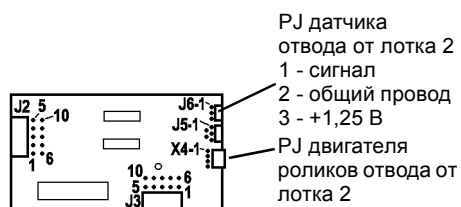
Рисунок 3 PWB управления лотка
