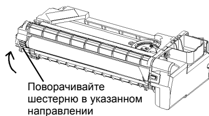
Рисунок 4 Вращение барабана
