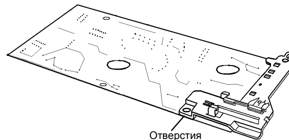
Рисунок 2 Совмещение отверстий
