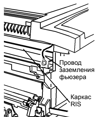
Рисунок 7 Провод заземления фьюзера
