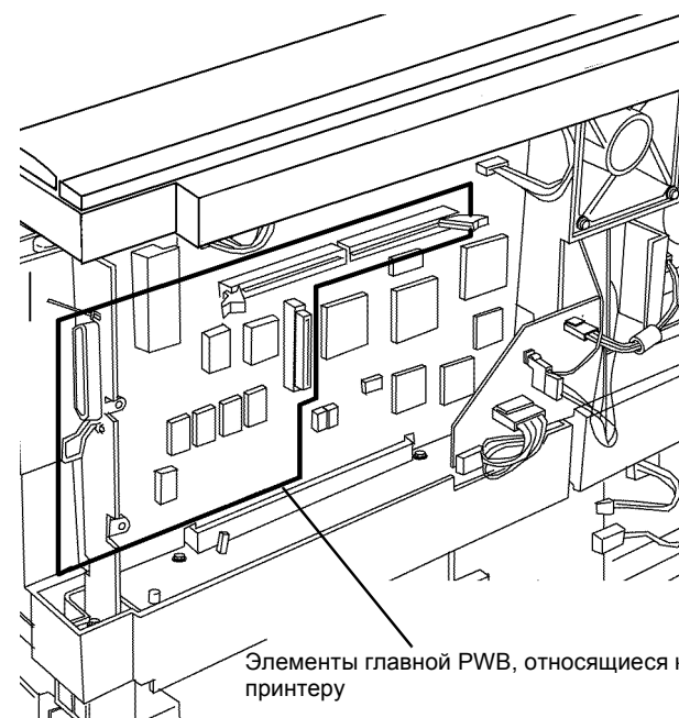
Рисунок 3 Главная PWB Print Components
