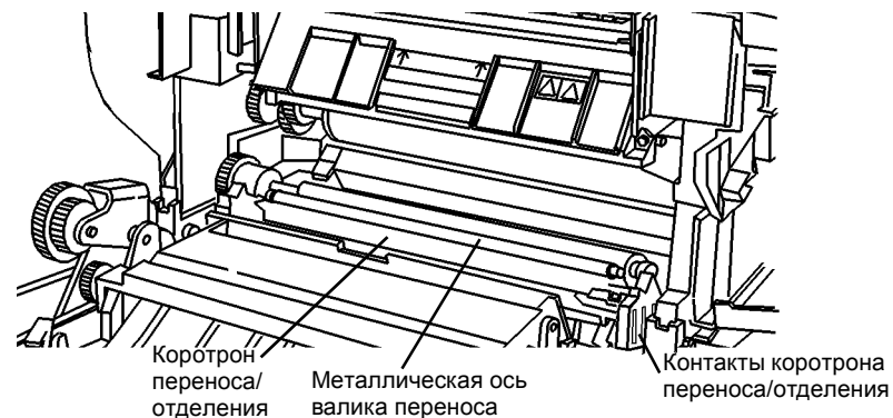
Рисунок 1 Контакты коротрона переноса/отделения
